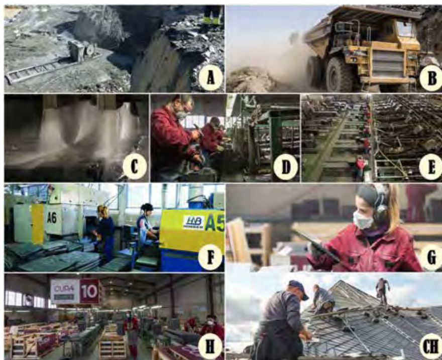
Obr. 1. Proces výroby pokrývačskej bridlice zdroje fotografií so súhlasom: benatural.es, cupapizarras.com, rathscheck.de
